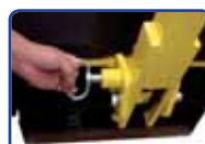
Amélioration de la poignée de verrouillage en position stockage
