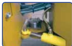
Articulation de pivot unique avec point de graissage
