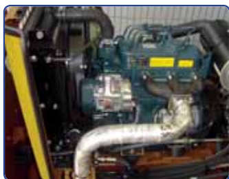
Moteur Kubota monté en ligne afin de créer un accès facile
