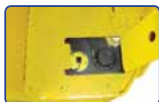
Accès facile au bouchon du réservoir gazoil sur le plancher opérateur
