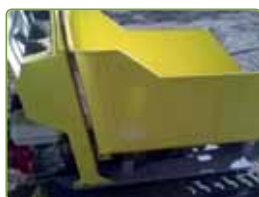
Benne acier, renforcée de 3mm d'épaisseur.
