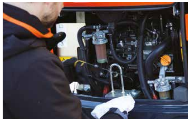
Les points d'inspection quotidienne sont regroupés pour garantir la facilité d'entretien.
