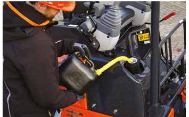
Espace suffisant autour de l'ouverture du réservoir de carburant pour une facilité de remplissage.
